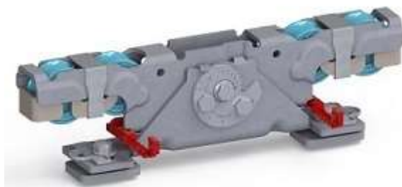
Doppelaufrollentechnologie samt Entgleisungsschutz und Exzentrerschraube zur Höhenangleichung
