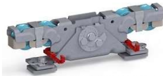
Doppelaufrollentechnologie samt Entgleisungsschutz und Exzenterschraube zur Höhenangleichung
