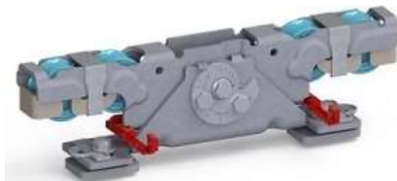
Doppelaufrollentechnologie samt Entgleisungsschutz und Exzenterschraube zur Höhenangleichung
